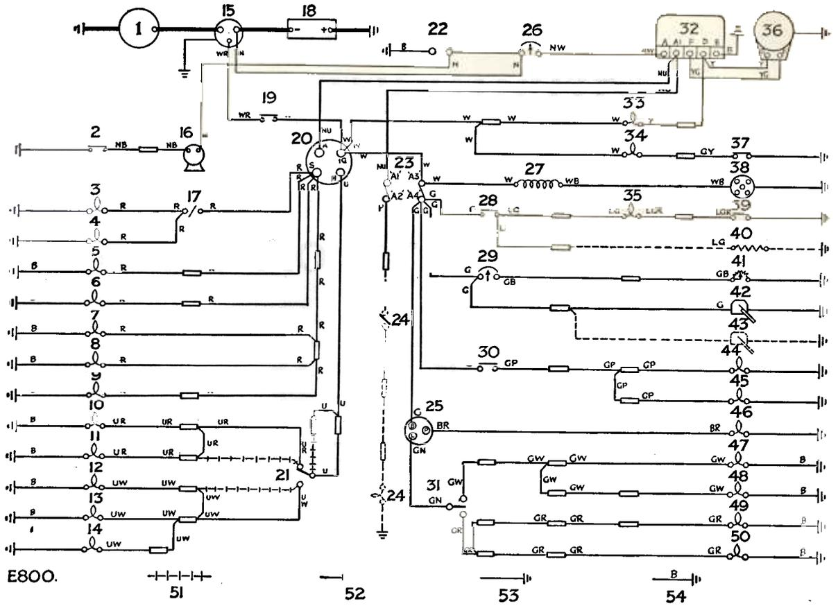
Fig. 27. Circuit diagram, 109 Forward Control 2 1/4 litre Petrol
